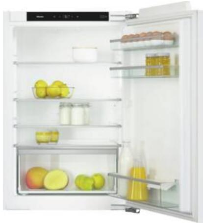
Einbau-Kühlschrank, Vollraum, integrierbar, Festtürmontage, Rauminhalt Kühlen: 144 l, Super-Kühlen, Glasablageflächen: 4, Obst-/Gemüsebehälter: 1, LED-Beleuchtung, Display, digitale Temperaturanzeige, Energieeffizienzklasse D, Breite: 55,8 cm, Höhe: 87,4 cm, Tiefe: 54,5 cm
